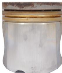
Die Ringstege und Ringnute der Gasmotorenkolben weisen nur geringe Ölkohle- und Lackablagerungen auf.
