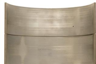
An den Pleuellagern waren weniger als 5% der Deckschicht abgetragen und kein Kupfer freigelegt. Das belegt ausgezeichneten Schutz vor Verschleiß und Korrosion trotz korrosiver Verunreinigungen im Treibgas.
