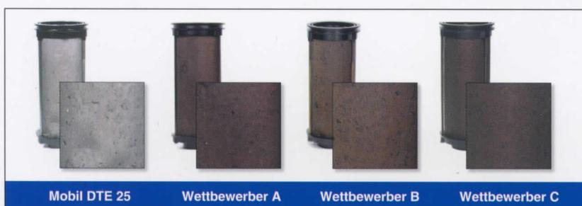
*Nach 750 Stunden MHFD-Prüfung (Mobil Hydraulik Fluid Durability Test) sind die Wettbewerbsprodukte ausgefallen und haben Ablagerungen zurückgelassen, die zu unberechenbarem Betrieb und verkürzter Lebensdauer der Anlagenbauteile führen können.*
