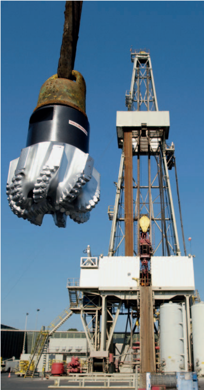
Montage eines Hightech-Meißels vor seinem ersten Einsatz auf einem Bohrplatz der ExxonMobil im niedersächsischen Walsrode.
