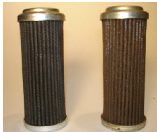
Saubere und verschmutzte Hydraulikfilter im Vergleich
