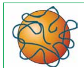
Hohe Temperatur: VI-Verbesserer – Die Moleküle dehnen sich aus
