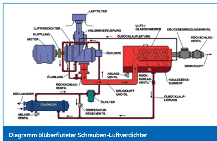
Diagramm öüberfluteter Schrauben-Luftverdichter
